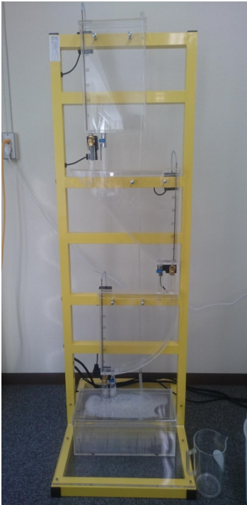
三重水槽を用いた 非線形プラントの制御
